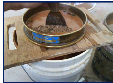
Lavado de arena por malla 200 y decantación de finos
